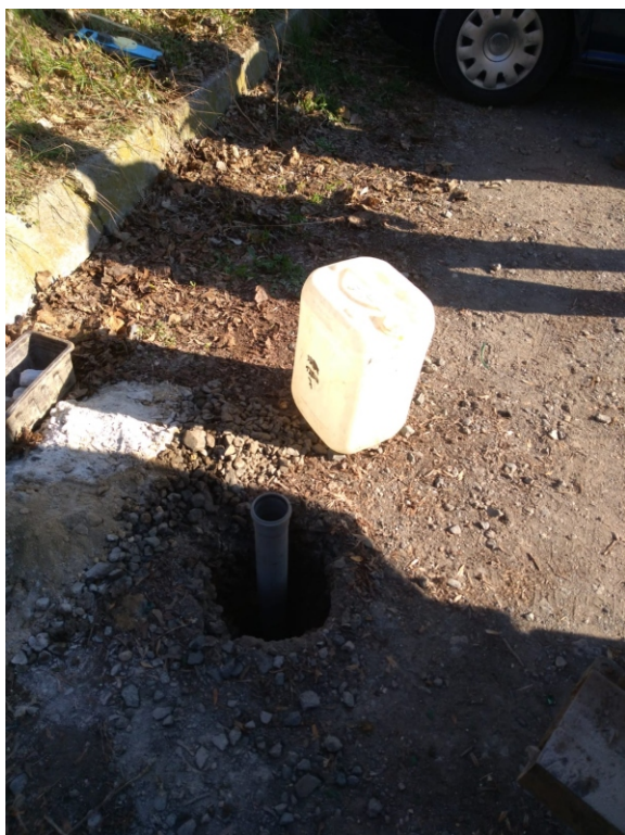
Foto 3 : realizace vsakovací zkoušky ve vrtu
